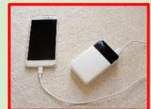
モバイルバッテリーやスマートフォンなどリチウムイオン電池が使われている製品は、外部からの強い衝撃や圧力を加えると短絡(ショート)し、過度の電流が流れ、発火の原因になります。
